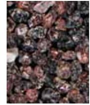
*10A: corindón normal. Resistente y duro para tronzado y desbastado con muela de aceros débilmente aleados.*
